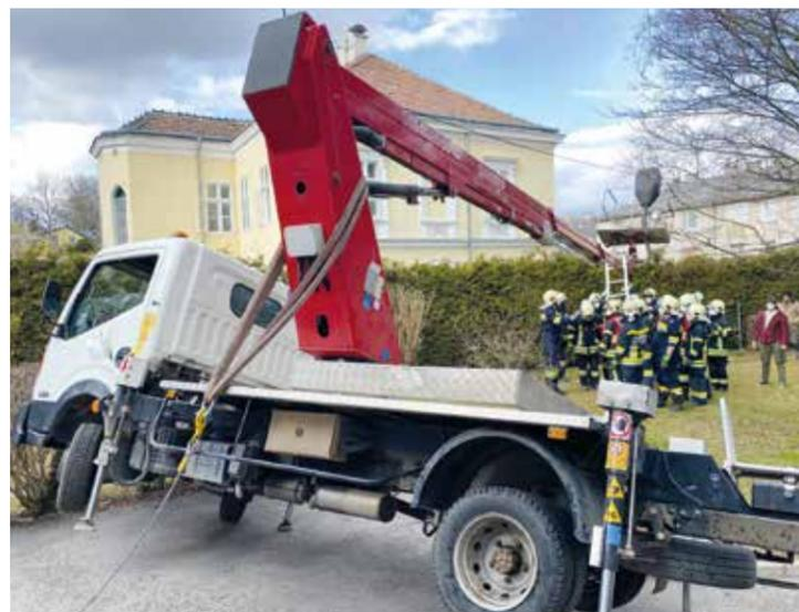
Beim Bedienen einer auf einem Klein-Lkw installierten Arbeitsbühne passierte offenbar ein Fehler, in Folge stürzte das gesamte Fahrzeug um. Ein auf der Arbeitsbühne stehender Mann konnte sich mit einem Hechtsprung aus 4 Metern Höhe gerade noch retten und blieb bis auf ein paar Kratzer augenscheinlich unverletzt. Mit vereinten Kräften und mit Hilfe des Greifzugs stellten die Mitglieder der Feuerwehr den Klein-Lkw wieder auf die Räder.
